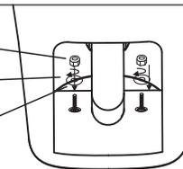
6. Pour installer le couvercle du siège et le bol en céramique : le couvercle du siège doit être aligné avec le bol en céramique.
