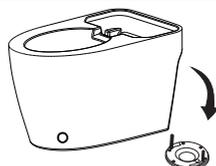
5. Utilisez une clé pour verrouiller l'écrou et les autres accessoires sur les boulons de retenue. (du haut)
